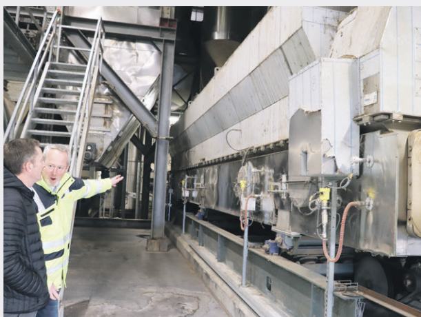
■ Hønsemøget tørres i denne enorme gryde, der ryster frem og tilbage. Hønsemøg har i forvejen en tørstofprocent på op til 68 procent.
