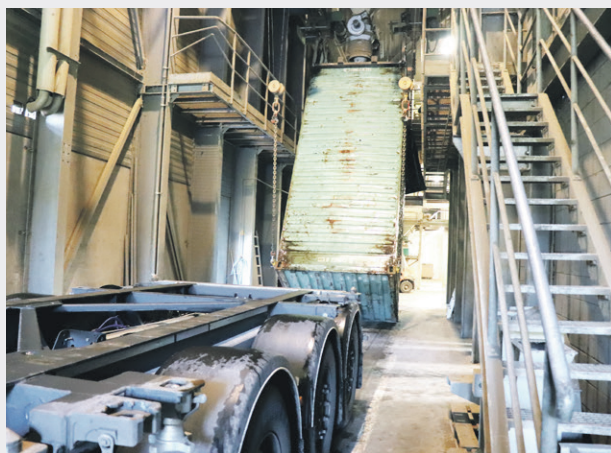
■ En tom container tages af lastbilen, tippes på skrå og fyldes fra oven med gødningspiller, inden den sejles til for eksempel Vietnam.
